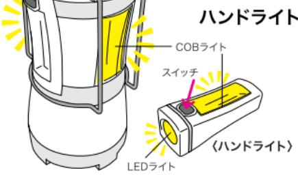
ハンドライトのスイッチを1回押すとLEDライトが点灯し懐中電灯として使えます。
